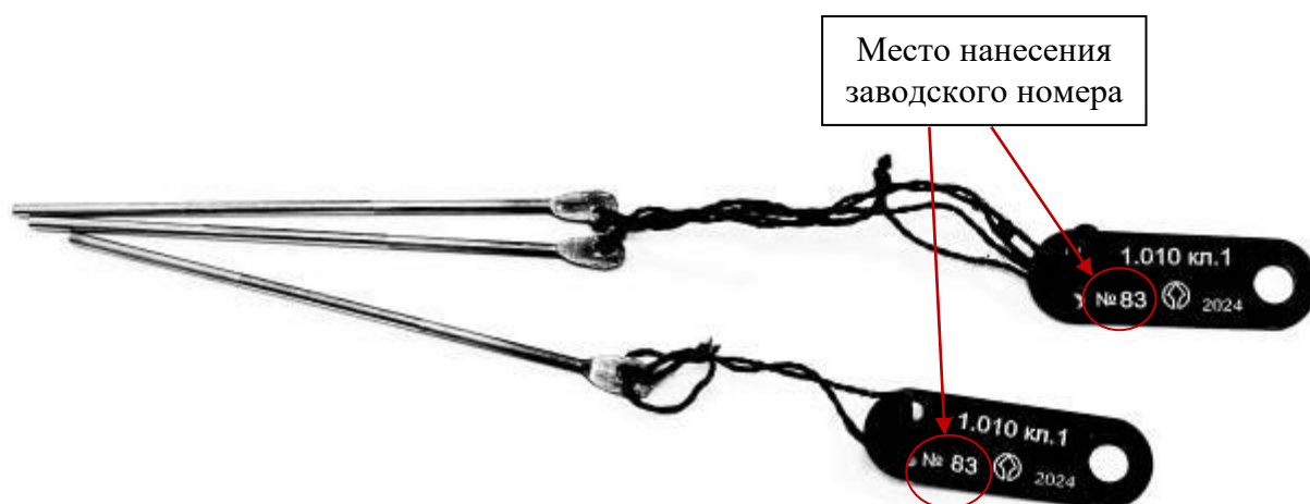
Рисунок 1 – Общий вид проволоочек гладких типа I с указанием места нанесения заводского номера
