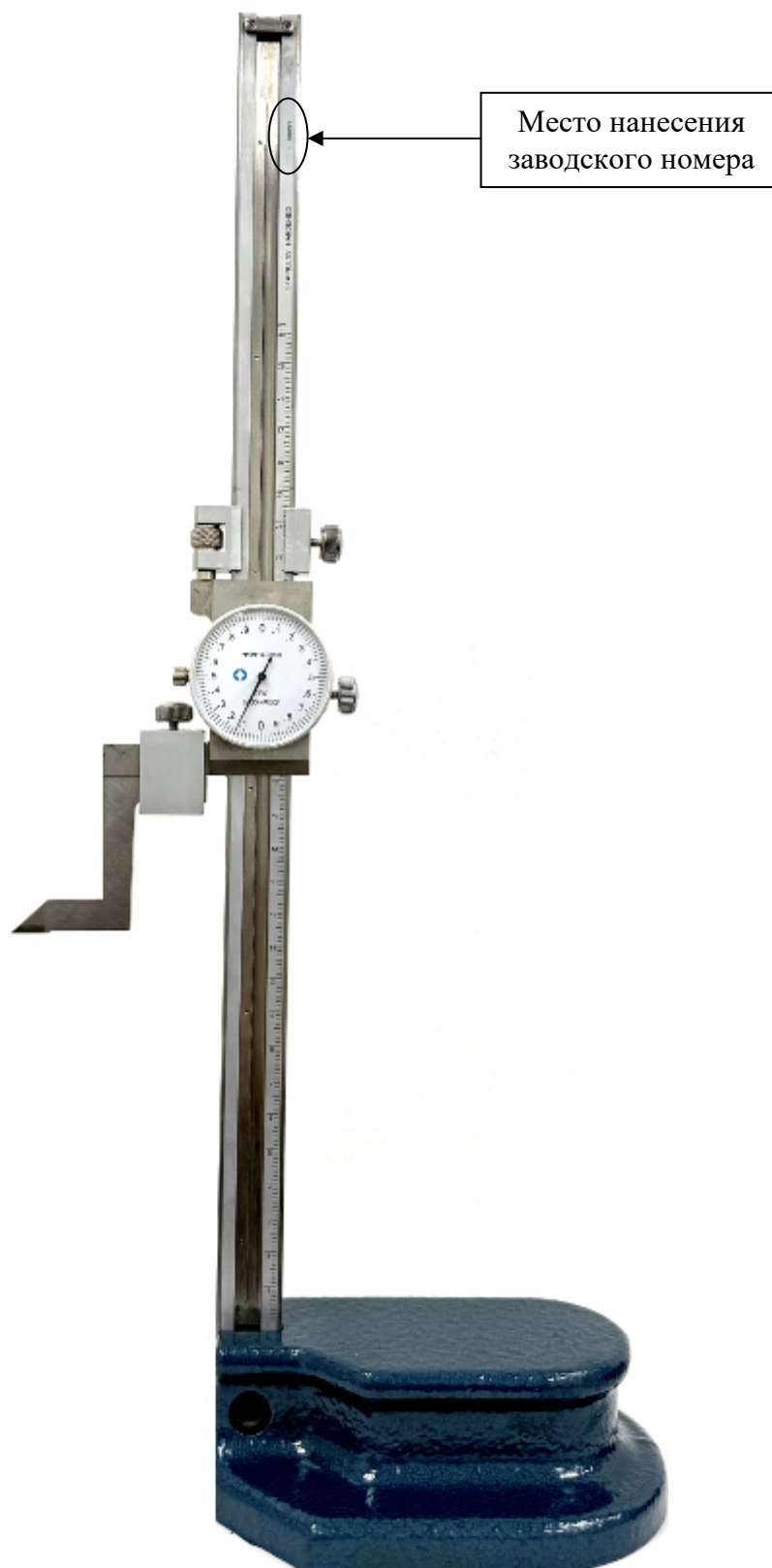
Рисунок 2 – Общий вид штангенрейсмасов с отсчетом по круговой шкале с указанием места нанесения заводского номера
